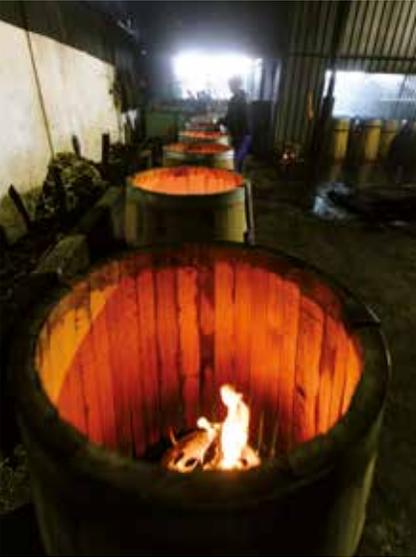
^ El calentamiento se vigila exhaustivamente termorregulando la temperatura que la barrica toma en el proceso y que permite otorgar distintos grados de tostado según el cliente.
